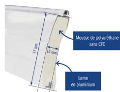
**Tablier :** lames avec nervures de 77 mm injectées de mousse de polyuréthane sans CFC. Ép. 15 mm.
